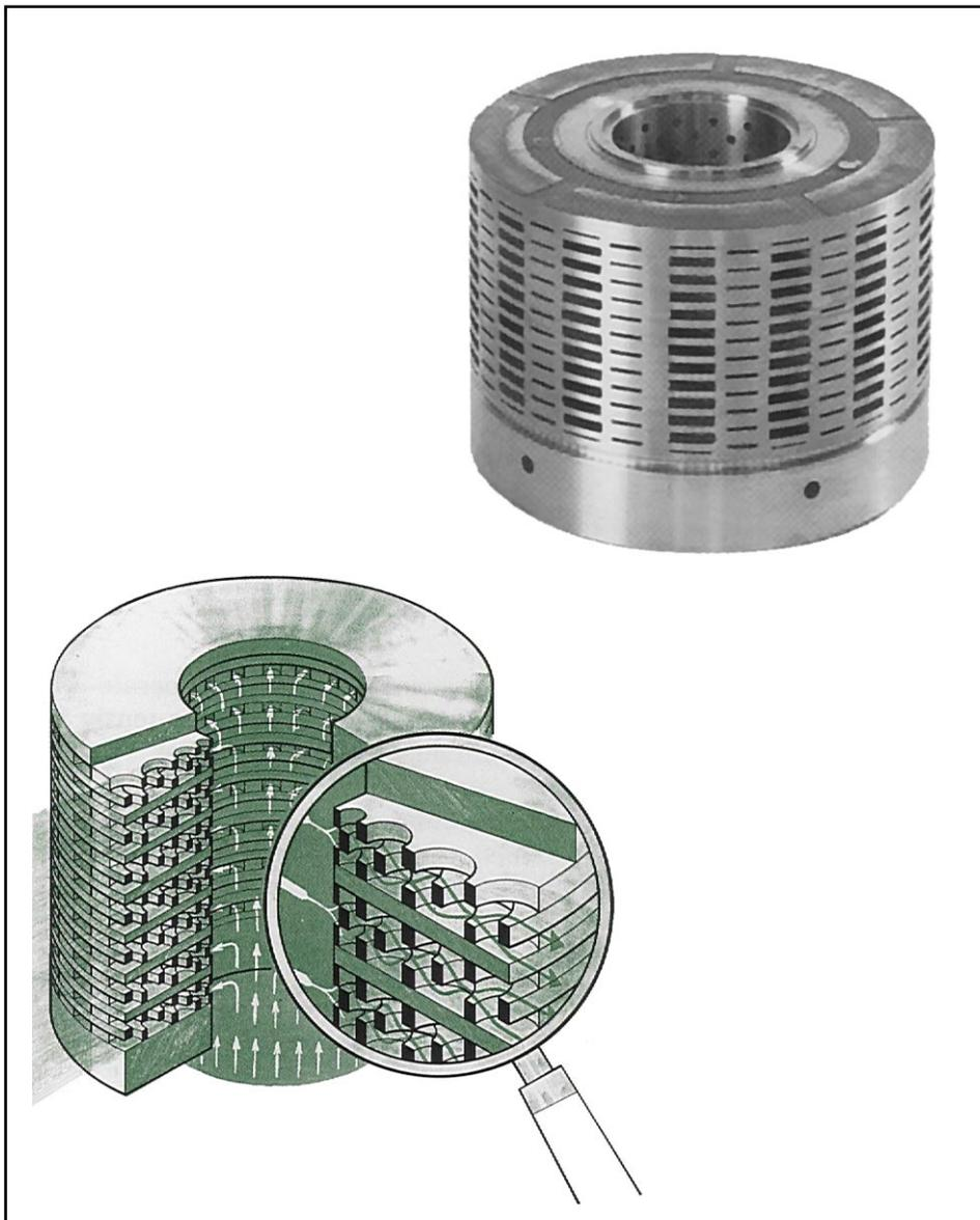
**Fig. 12** *Trim di valvole di regolazione tipo LIMIPHON del tipo universale multistage/multipath con pacco di dischi a labirinto. I passaggi del fluido sono ottenuti mediante la sovrapposizione dei dischi opportunamente forati e orientati fra di loro.*
